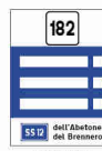
PROGRESSIVA Distanziometrica INTEGRATA CON SEGNALE DI CONFERMA SU STRADE EXTRAURBANE Fig. II 265 Art. 129
